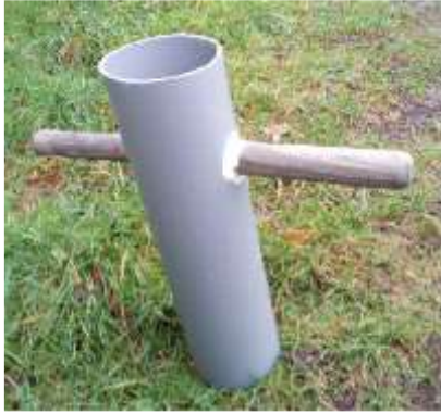
Carottier : surface échantillonnée de 135 \text{ cm}^2 . Épuisette : échantillonnage sur 360 \text{ cm}^2 .
